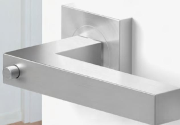
**Überzeugt durch seine kinderleichte Handhabung. Um die Tür zu verriegeln, drücken Sie einfach den Pin in den Türgriff. Um das Schloss zu öffnen, reicht das Herunterdrücken des Türgriffs. Wird der Außentürgriff bei abgeschlossener Tür betätigt, läuft dieser einfach ins Leere und es wird kein zusätzlicher Druck auf Schloss und Vierkantstift ausgeübt.**
